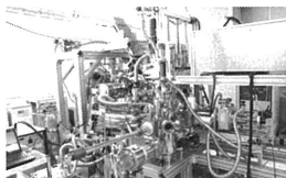
▲ In-situ XPS Tribosystem (摩擦面のその場分析装置、共同開発品)
